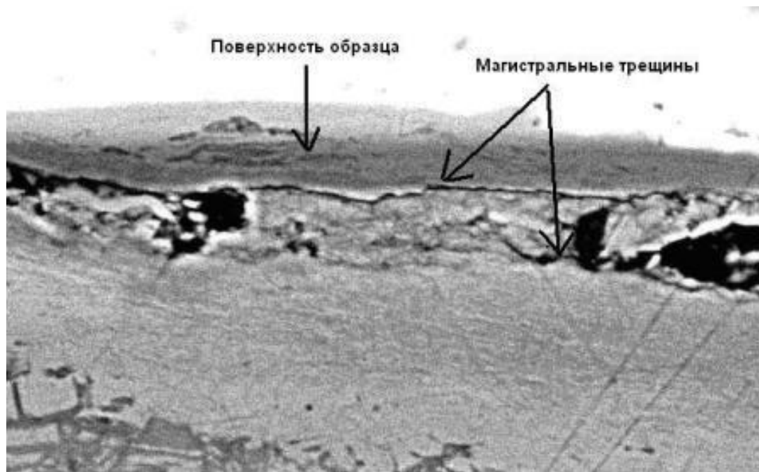
Рисунок 30 – Растровая электронная микроскопия приповерхностного слоя облученного образца стали 12X18H10T ( отметка «+175» от ЦАЗ).
