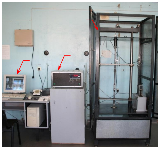
1 – нагревательная камера; 2 - датчики измерения деформации образцов; 3 – захваты; 4 – тяги; 5 – редуктор; 6 – цепная передача; 7 – динамометр; 8 – образец; 9 – установка; 10 – блок управления; 11 – рабочее место оператора
