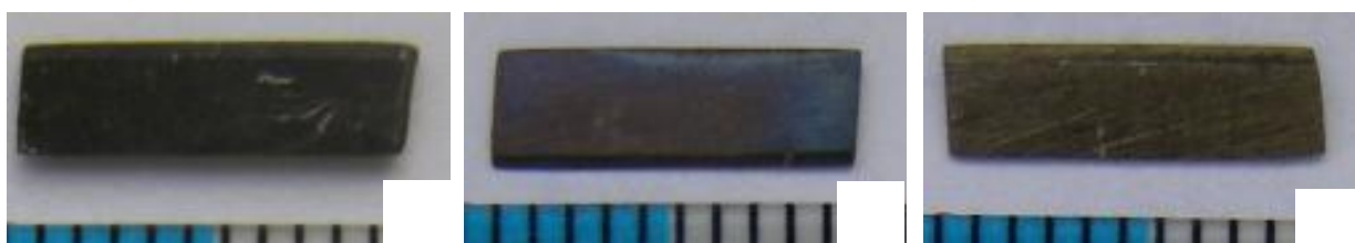
Рисунок 34 – Внешний вид образцов после отжига при температурах 550 (а), 400 (б) и 300°С (в) в течение 7000 часов в среде аргона
