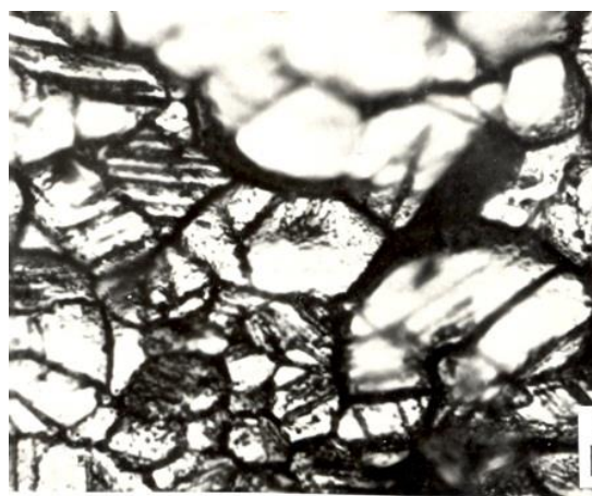
б) характер коррозионного растрескивания
