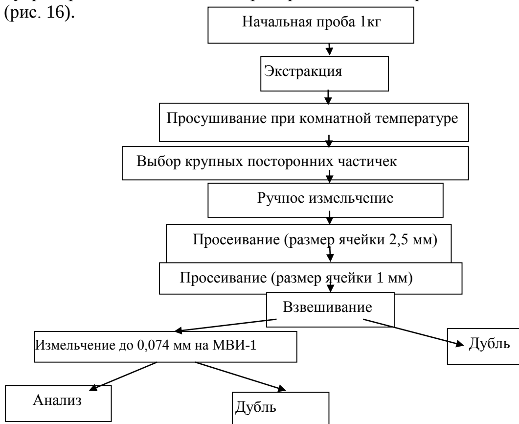
Рис. 16. Схема подготовки пробы донных отложений для анализа в лаборатории
