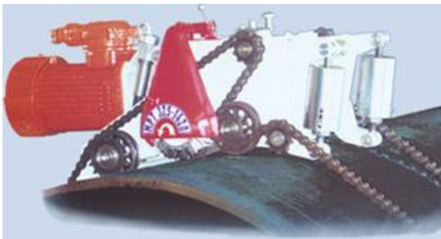
Рисунок 3 – Машина для безогневой резки труб МРТ "Волжанка-2"
