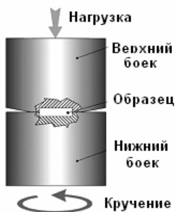
Рисунок 1.1 – Схема интенсивной пластической деформации методом КВД [1,17]
