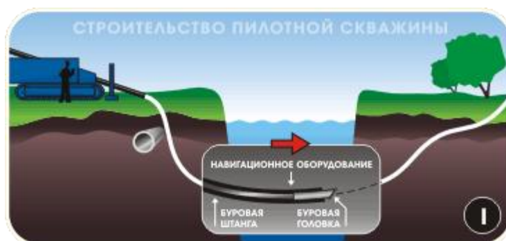
Рис 7.2 Строительство пилотной скважины
