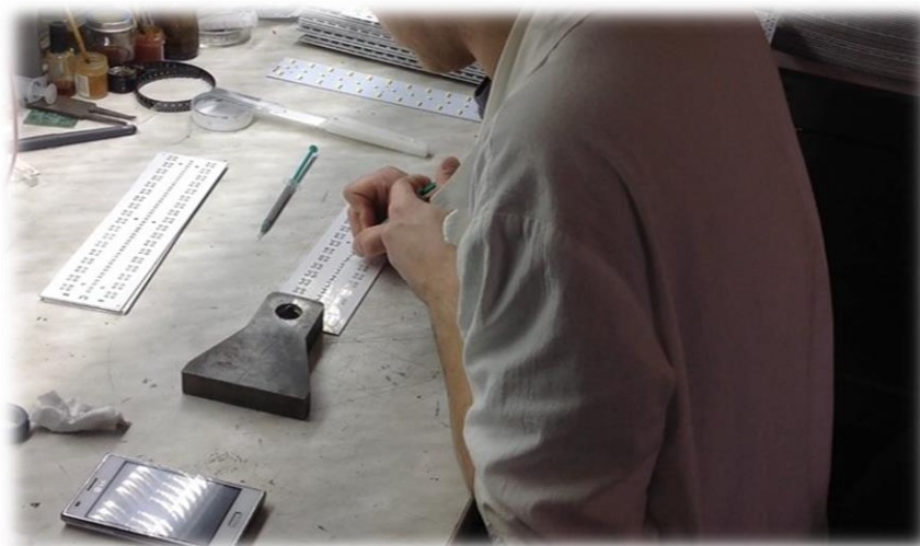
Рисунок 9 – Отсутствие трафарета при нанесении паяльной пасты
