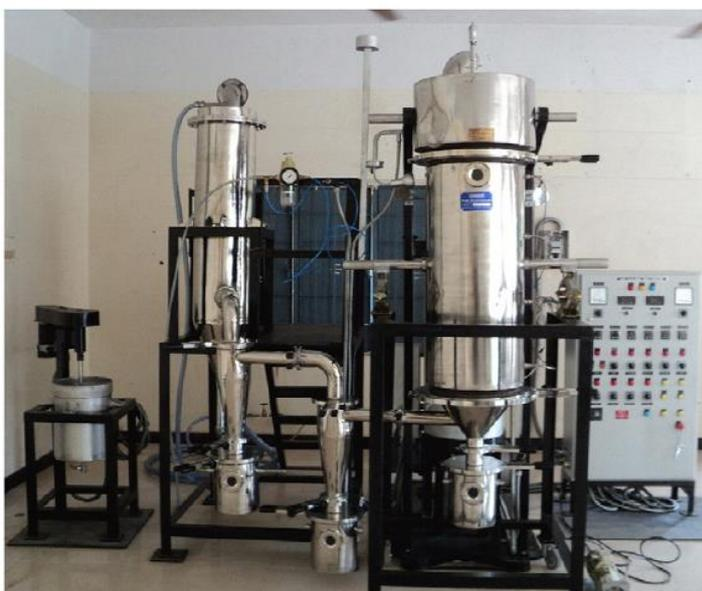
Рисунок 1 - горячего воздуха пиролиза распыления (*hot-air spray pyrolysis*)
