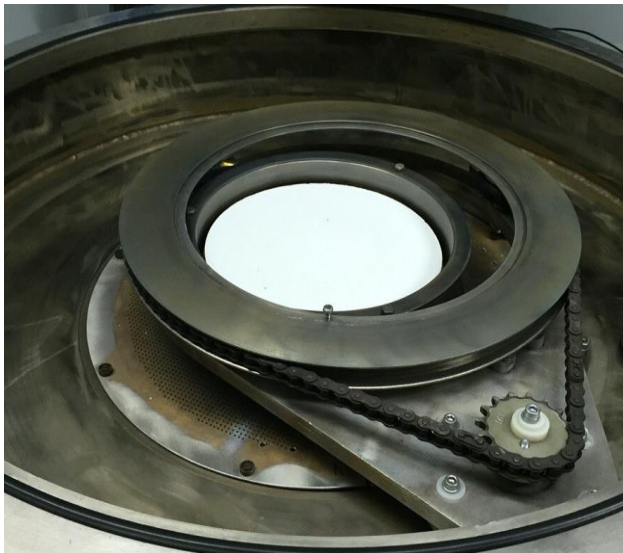
Рисунок 2.2.4 – Вакуумная камера используемой установки с размещенной мишенью ( \text{Ca}_{10}(\text{PO}_4)_6(\text{OH})_2 ) внутри
