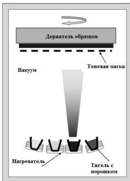
Рисунок 2.4 – Схема термического испарителя [45]
