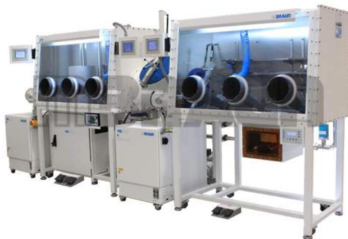
Рисунок 2.3 - Перчаточный бокс MB-200B фирмы MBraun
