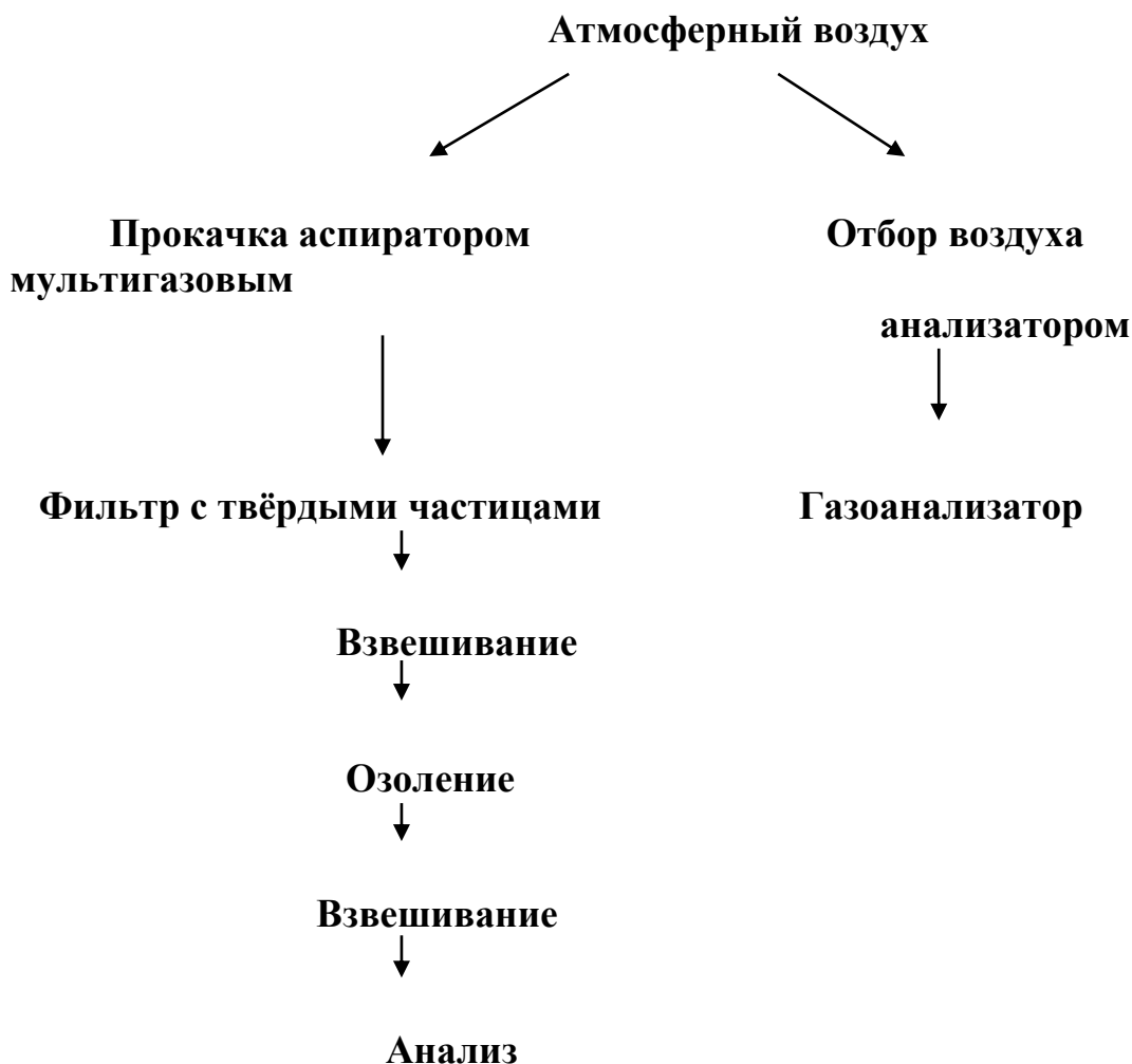
Рис.6.1. Схема обработки проб атмосферного воздуха [3]
