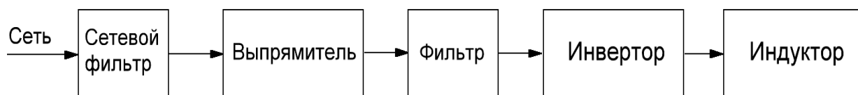
Рисунок 1.1 –Упрощенная схема преобразователей для индукционного нагрева.
