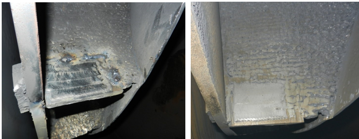
Рисунок 13 – Слева – пластина с четырьмя валиками, нанесенные с помощью ППН, свареная в лопасть рабочего колеса. Справа – результат изнашивания после 1 года эксплуатации.
