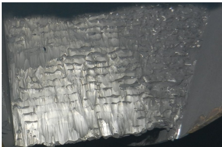
Рисунок 12 - изношенной поверхности лопасти рабочего колеса мельничного вентилятора, выполненной ручной дуговой наплавкой покрытыми электродами Т-590, после года эксплуатации.
