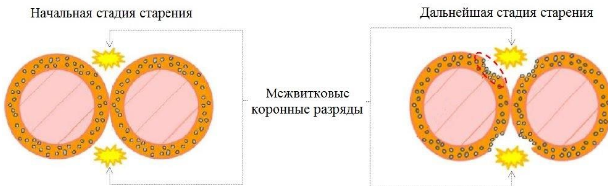
Рисунок 2 – Электрическое старение короностойких проводов
