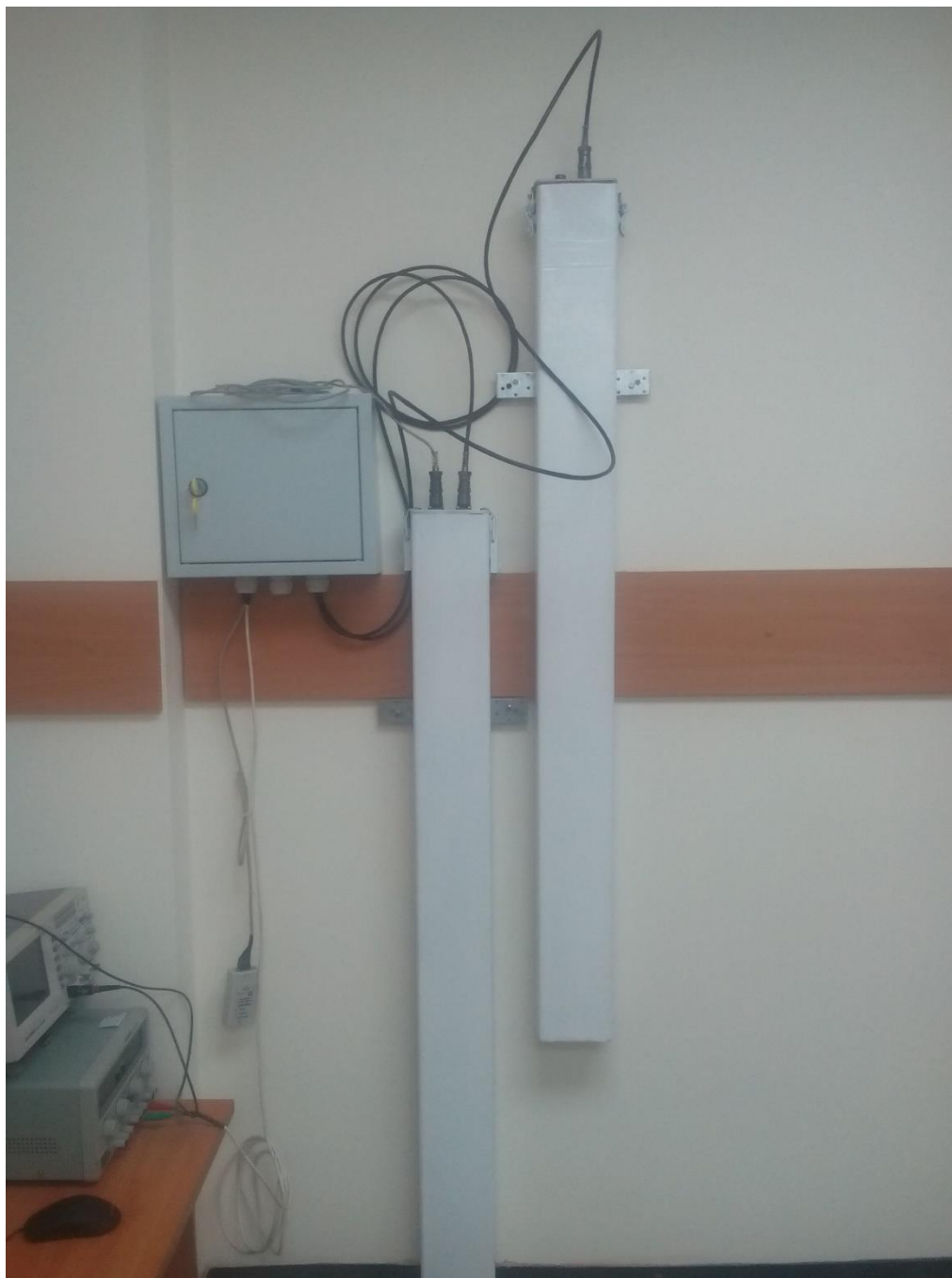
Рисунок 6.1 – Внешний вид образца гамма-уровнемера.
