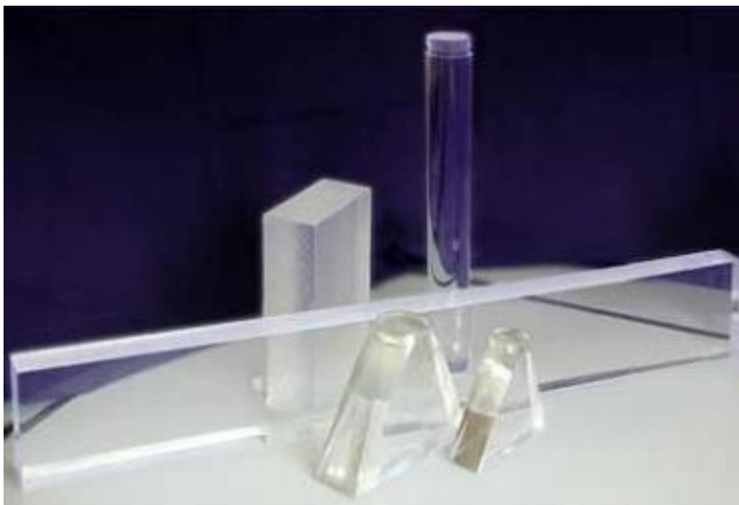
Рисунок 5.2 – Органический пластиковый сцинтилляционный детектор
