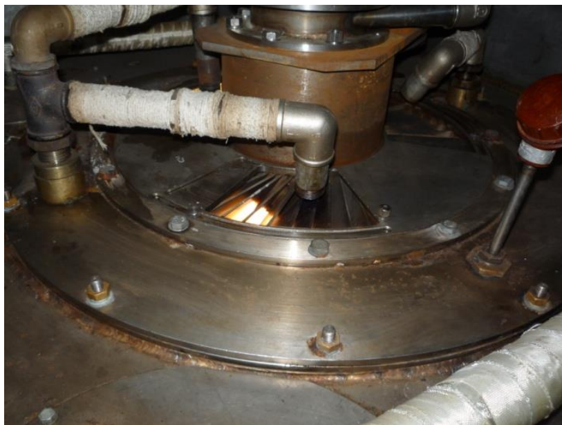
Рисунок 3.9 – «Розжига» реактора плазменного стенда на базе ВЧФ-плазмотрона
