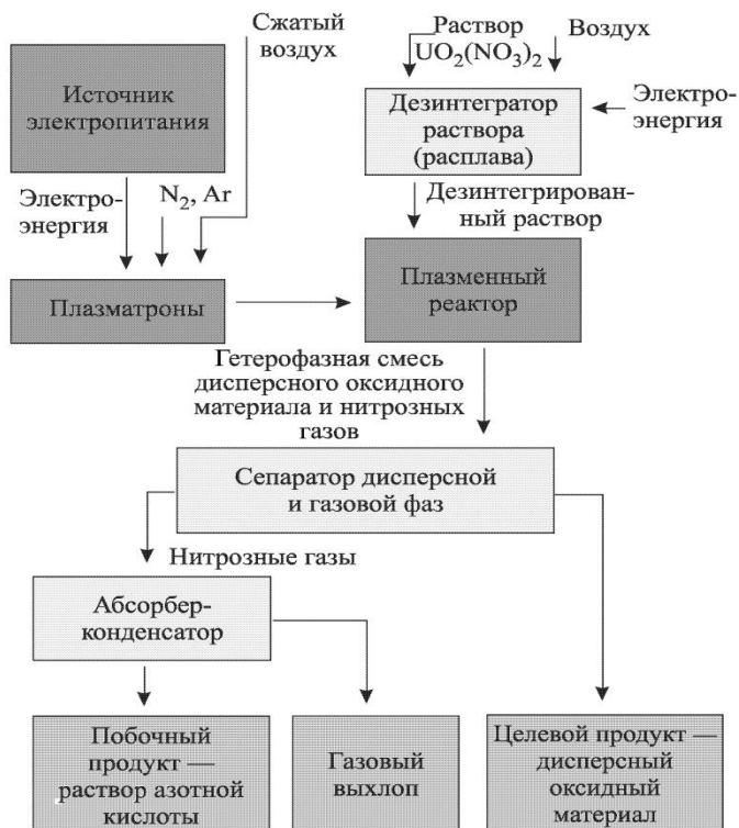
Рисунок 1.3 – Брутто-схема плазменного процесса разложения нитратных растворов урана на оксиды урана и азотную кислоту
