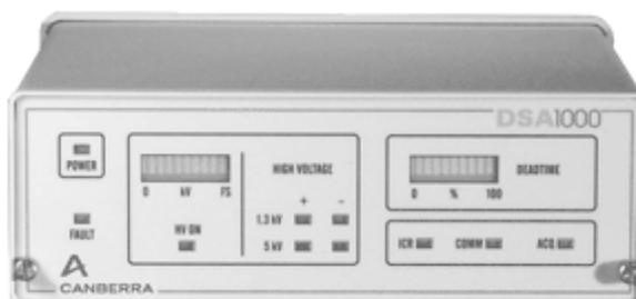
Рисунок 7 – Цифровой анализатор спектра DSA-1000
