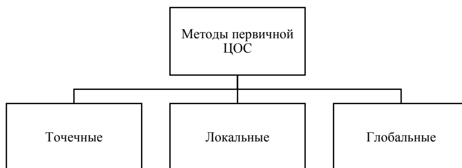
Рисунок 7 – Классификация методов ЦОС по принцип формирования отдельного отсчета результата исходного сигнала
