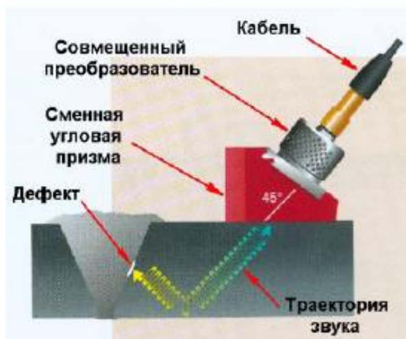
Рисунок 5 – Схема контроля совмещенным преобразователем при эхо-методе
