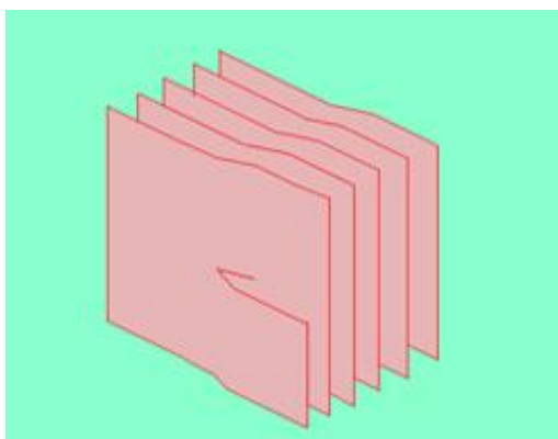
Рисунок 1. Схематическое изображение винтовой дислокации [6]
