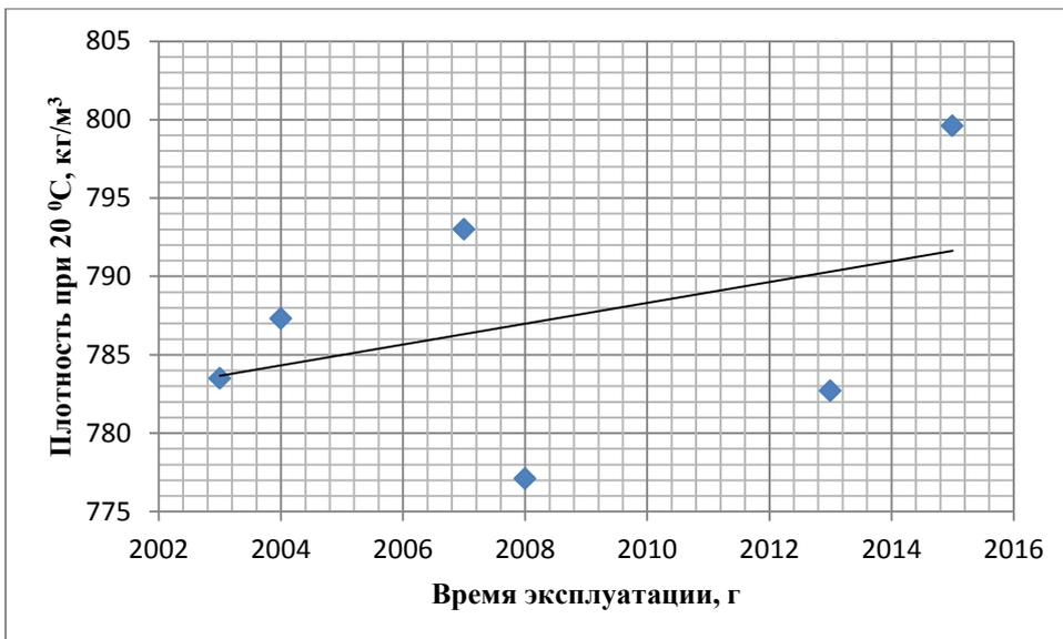
Рисунок 2.3 – Зависимость изменения плотности от времени эксплуатации скважины. ( Скважина № 118)
