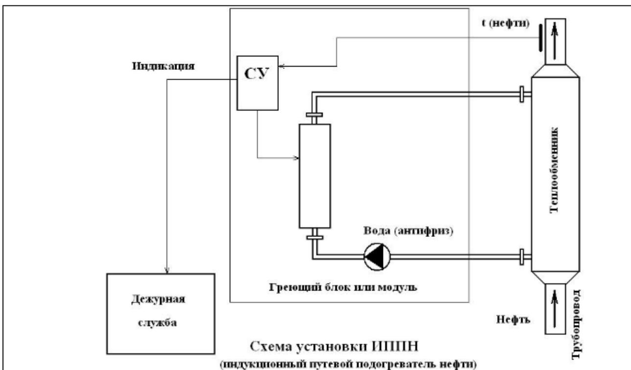
Рисунок 1. Установка ИППН завода «ЗИЭН» [14]
