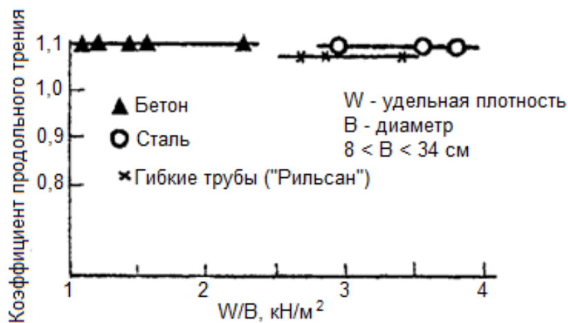
Рис. 2.1.2. Продольное трение различных трубопроводов об известковый песок.
