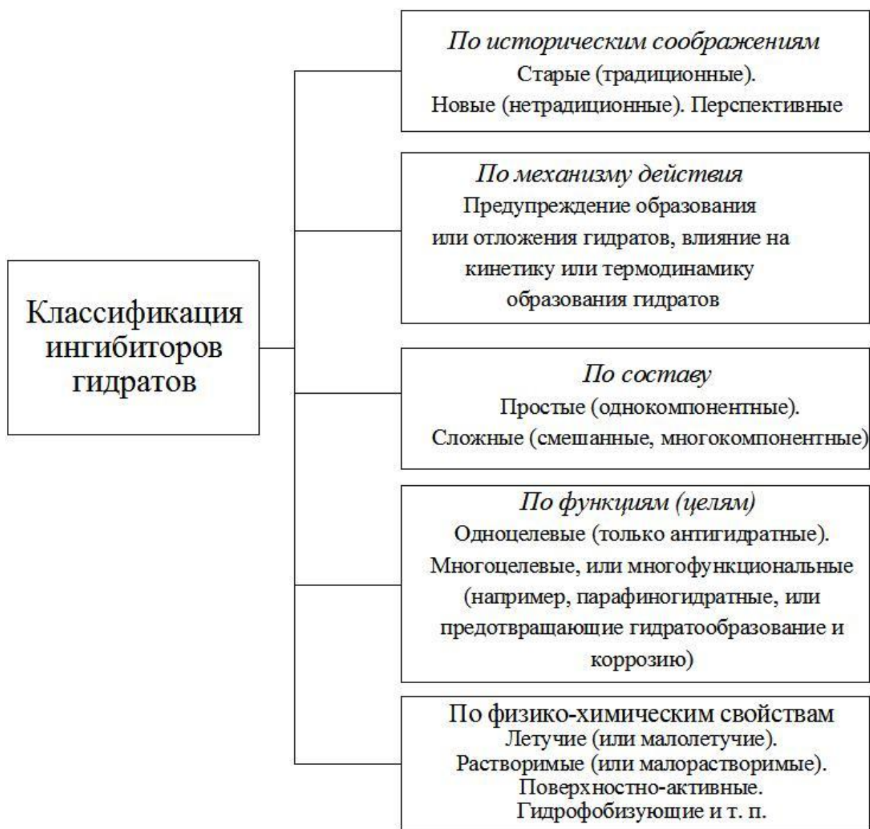
Рис.5.3 Классификация ингибиторов гидратов
