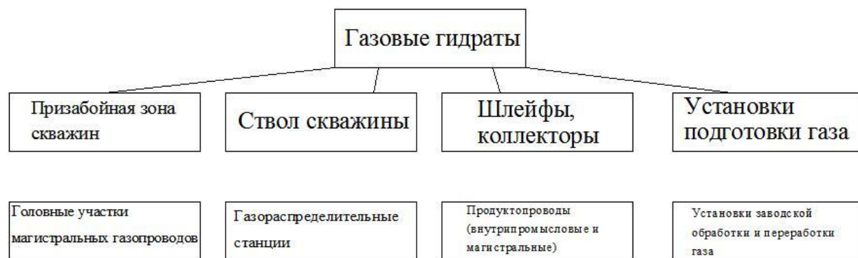
Рис. 5.1 Газопромысловые системы, в которых возможны техногенные гидратообразования
