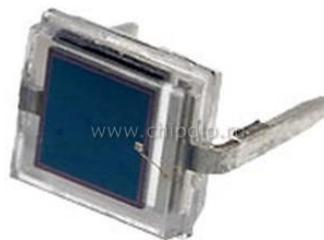
Рисунок 4. Внешний вид p-i-n- диода марки "BPW34"
