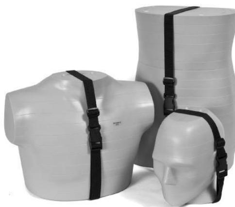
Рисунок 3. Дозиметрический фантом
