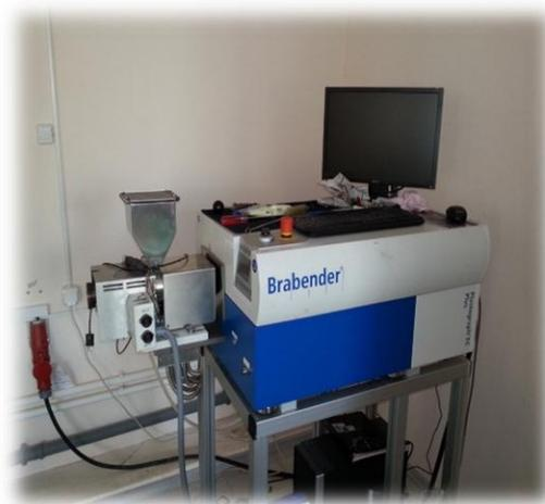
Рисунок 10 Brabender Plastograph EC Plus
