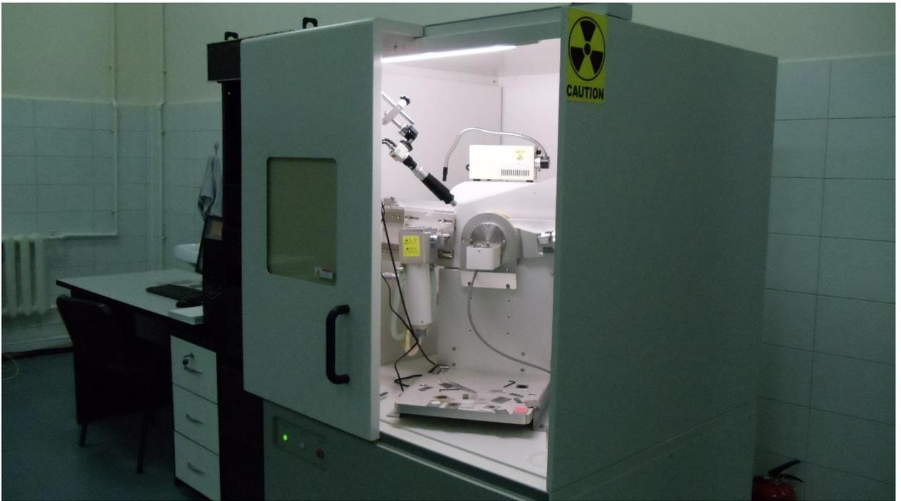
Рисунок 2.4. Дифрактометр Shimadzu XRD-6000
