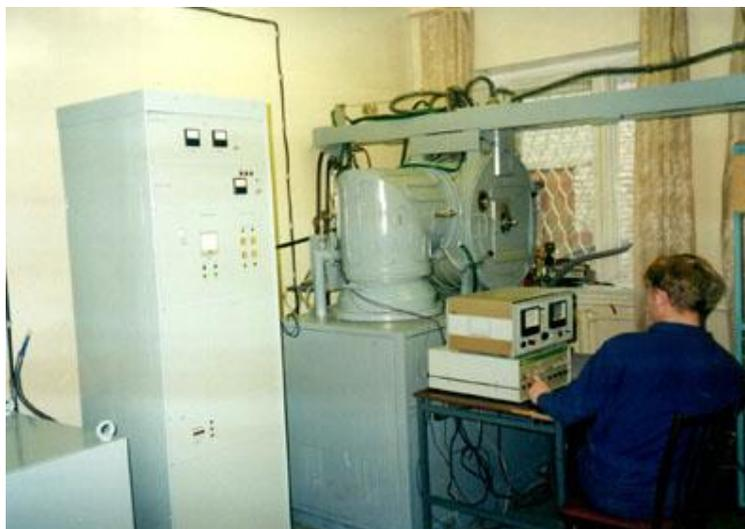
Рисунок. 2.2.1 Установка лабораторная высокочастотного магнетронного напыления (УВМН)
