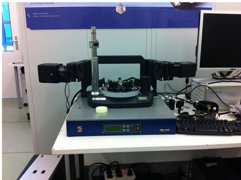
Рис. 2.3. Атомно-силовой микроскоп
