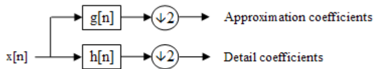
Рисунок 3.2 – Схема разложения сигнала в ДВП
