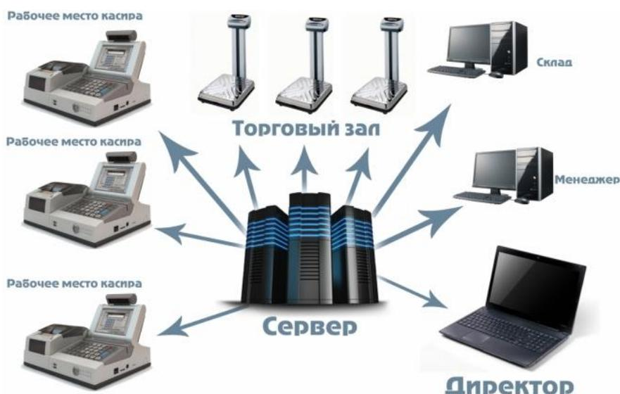
Рисунок 34 – Общая схема автоматизации торговли
