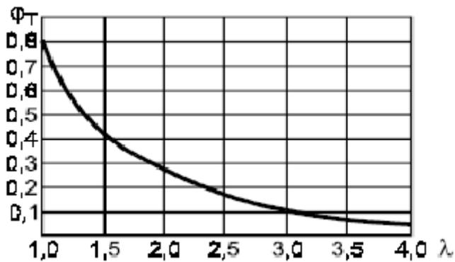
Рис. 15 Коэффициент уменьшения допускаемого напряжения при продольном изгибе
