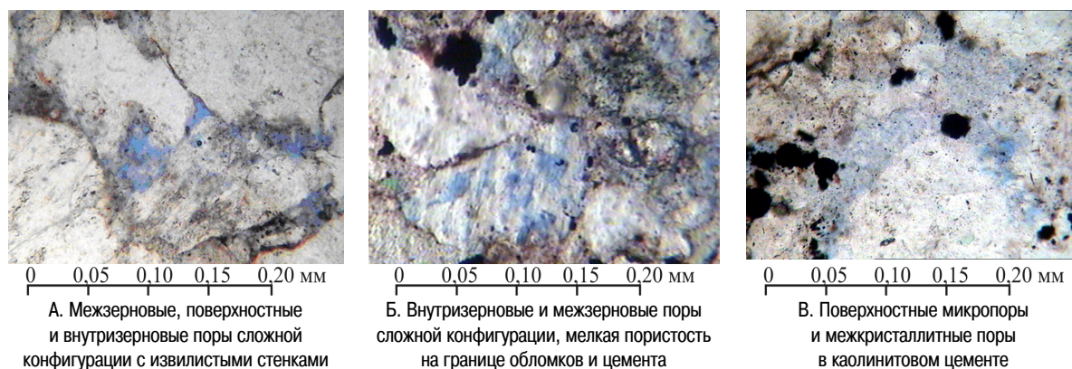
Рис. 3. Особенности пустотно-порового пространства в песчаниках из безбитумной подзоны растворения
