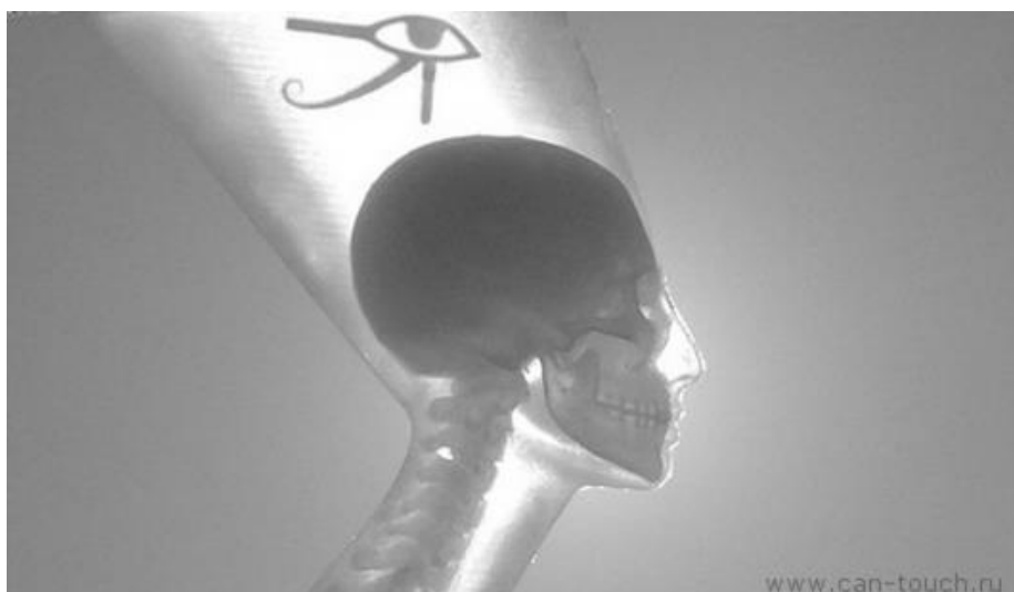
Рисунок 9.3. Материал VisiJet Crystal в совокупности с непрозрачным материалом.
