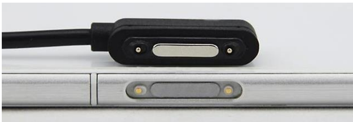
Рисунок 7.3. Смещенные контактные площадки у устройства от «Sony».
