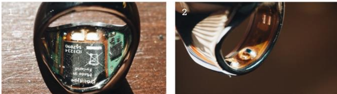
Рисунок 3.2. Внутренние компоненты кольца «Oura».
