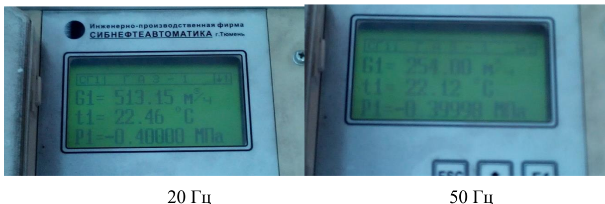
Рисунок 48 - Показания расхода с датчика БКТ.М
