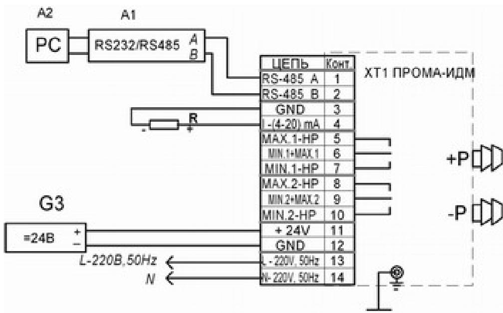
Рис.2 Схема внешних подключений ПРОМА - ИДМ4Х
