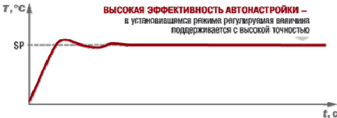
Рис.10 Эффективность автонастройки ПИД-регулирования
