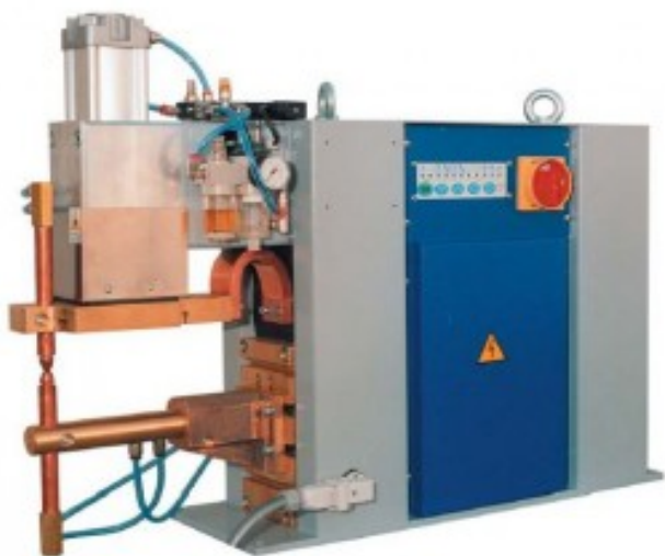
Рисунок 11-Машина точечной сварки с линейным прижимом PEI-POINT PF 136
