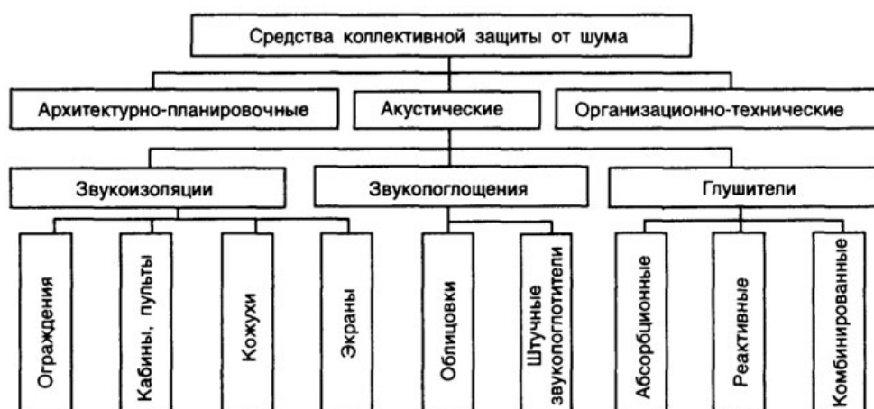
Рисунок 1- Средства коллективной защиты от шума на пути его распространения
