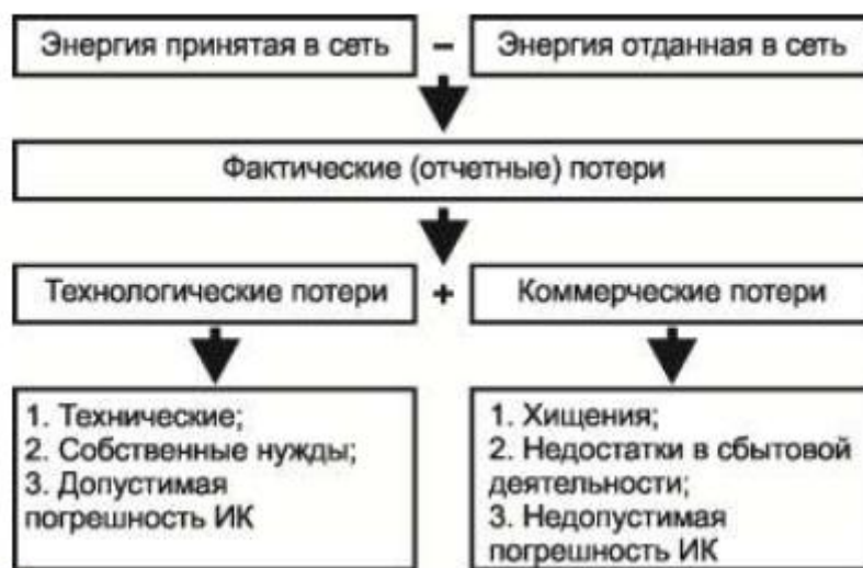
Рисунок 1. Структура потерь электроэнергии на стадиях передачи и распределения
