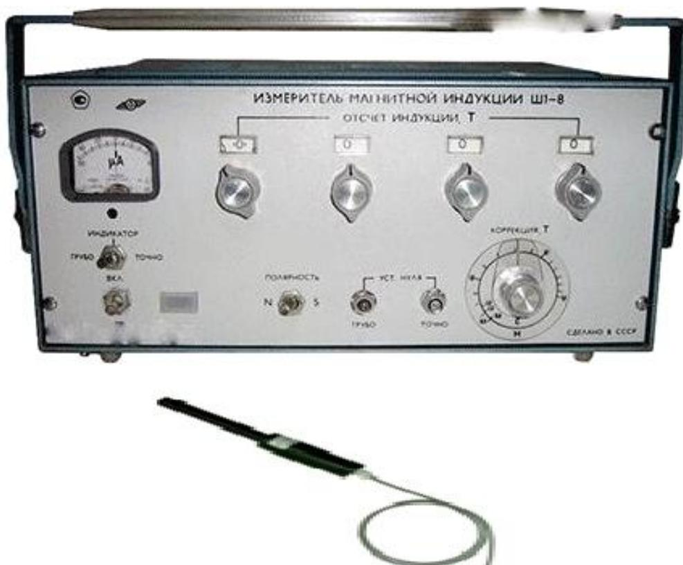
Рисунок 4 – Измеритель магнитной индукции Ш1-8 с зондом.
