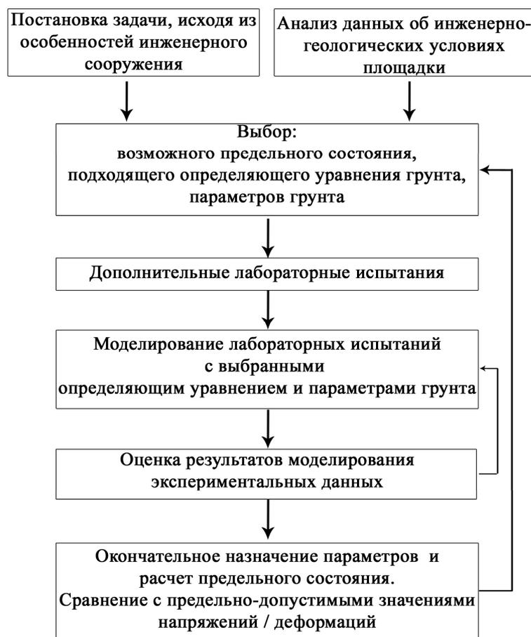
Рисунок. Порядок процедур создания цифровой расчетной модели
