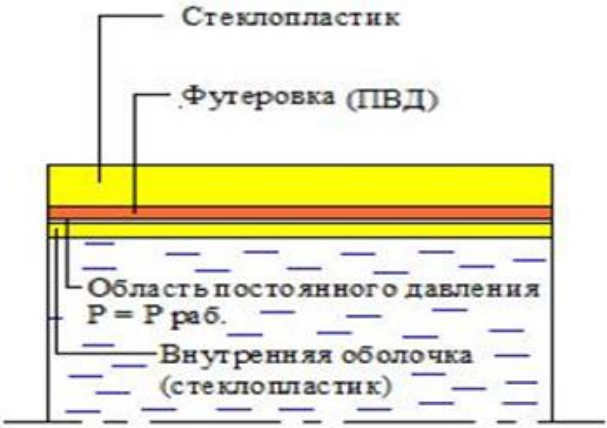
Рисунок 8 – Конструкция трехслойной трубы
