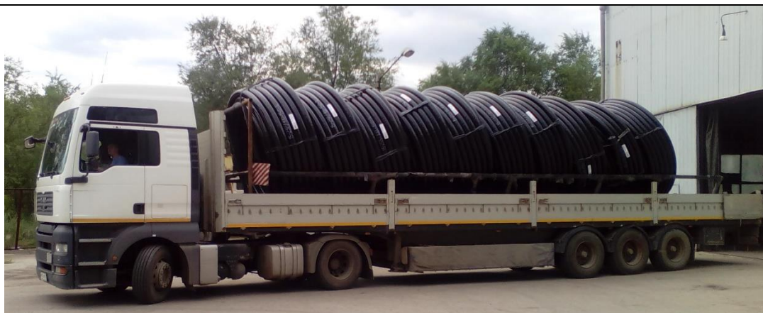
Рисунок 2. Транспортировка полимерных труб в бухтах.
