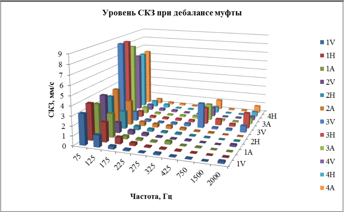
Рисунок 4 – Уровень СКЗ при дебалансе муфты.
