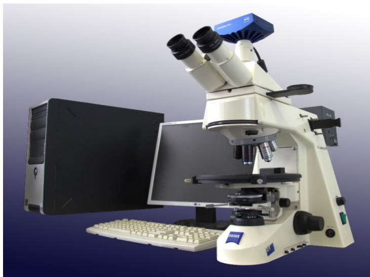
Рисунок 1 – Микроскоп Axioskop 40 с закрепленной на нем сверху камерой и подключением к компьютеру.
