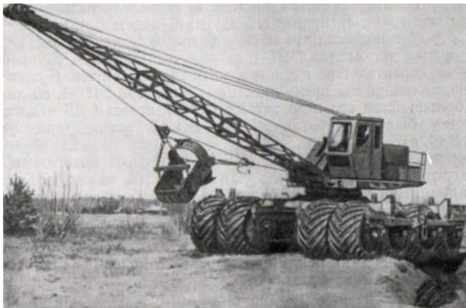
Рис. 6. Экскаватор с сильно развитой опорной поверхностью с пневматическими катками-понтонами ЭКБ -1
