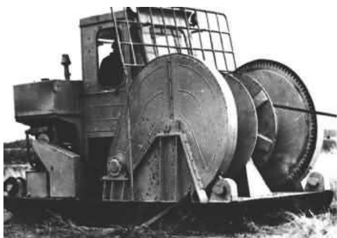
Рис. 2. Лебедки скреперные: а - ЛС302; б - ЛС1001
