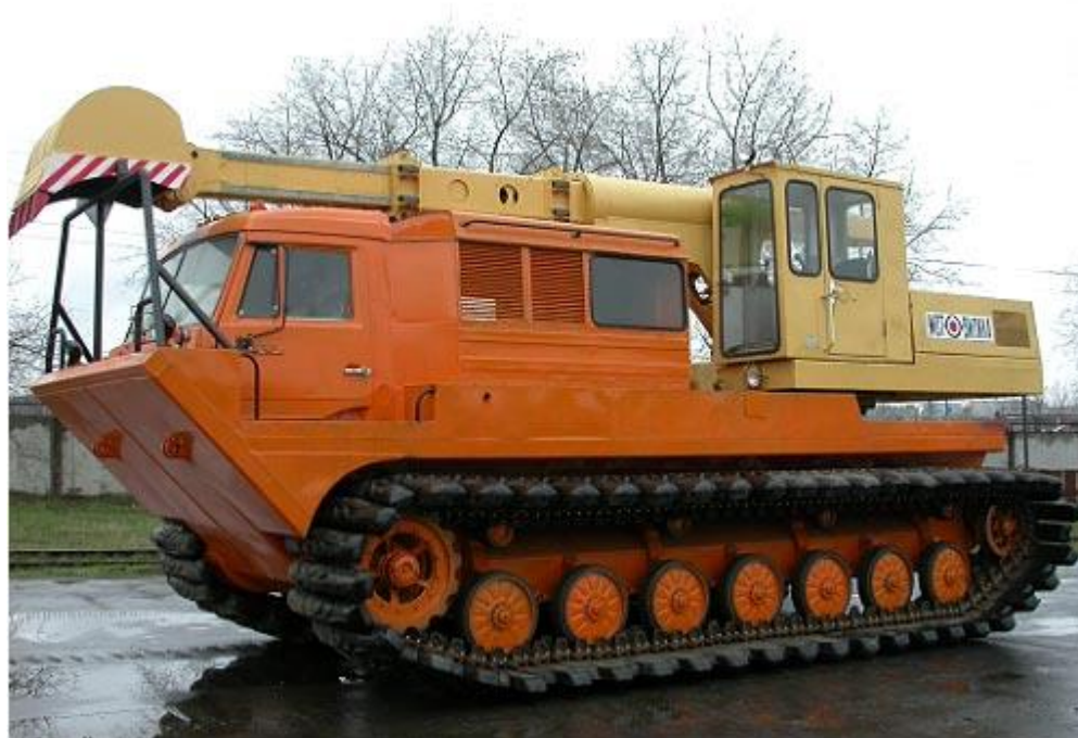
Рис. 10. Современный плавающий экскаватор ТТМ-6901Э
