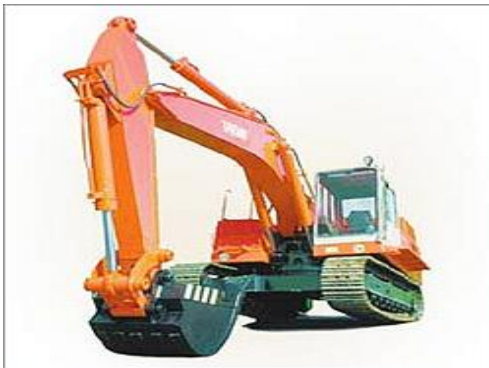
Рис. 7. Экскаватор с сильно развитой опорной поверхностью с резинометаллической гусеницей ЭО-5126
