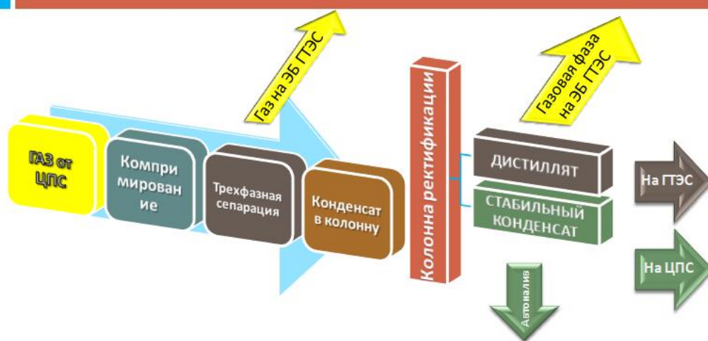
Рисунок 1 – Принципиальная схема УКПГ Рогожниковского месторождения
