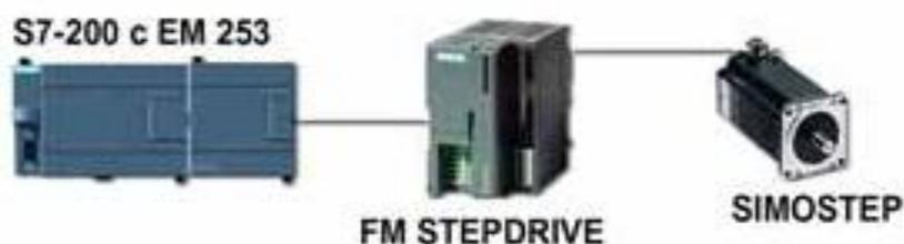
Рисунок 5 - Модуль позиционирования EM 253
