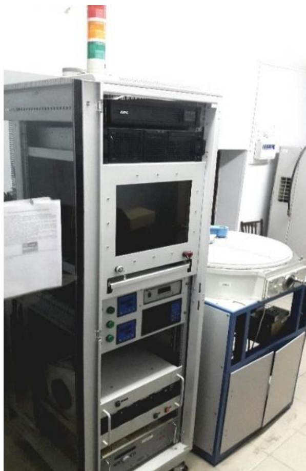
Рисунок 3.2.1 – Автоматизированная вакуумная ионно-плазменная установка модифицирования поверхности материалов медицинского назначения
