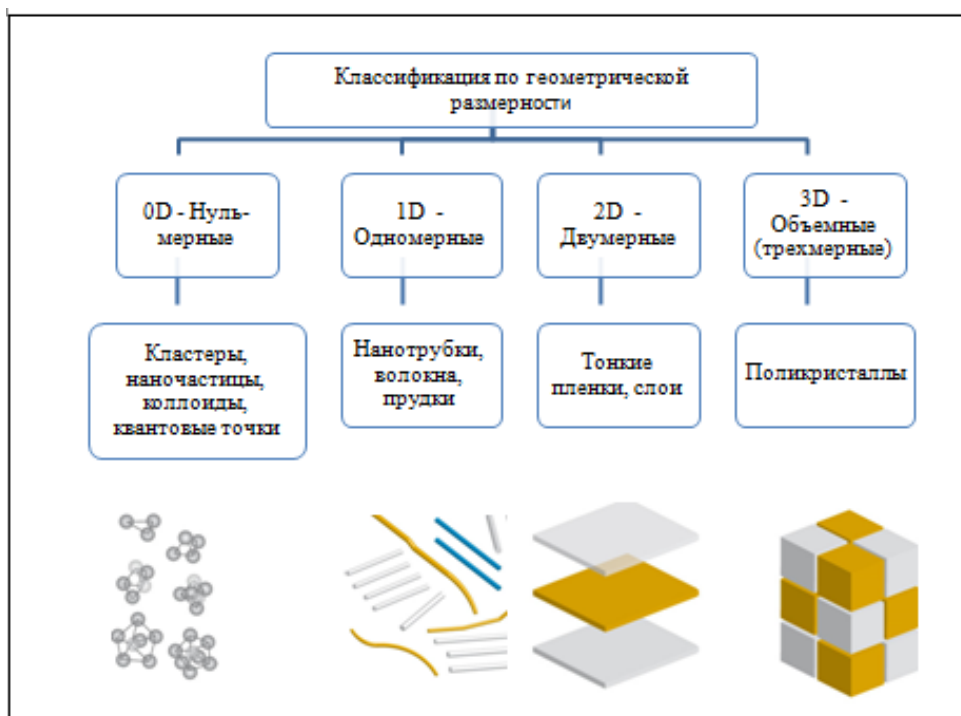
Рисунок 2 – Классификация наноструктурированных материалов по Зигелю
