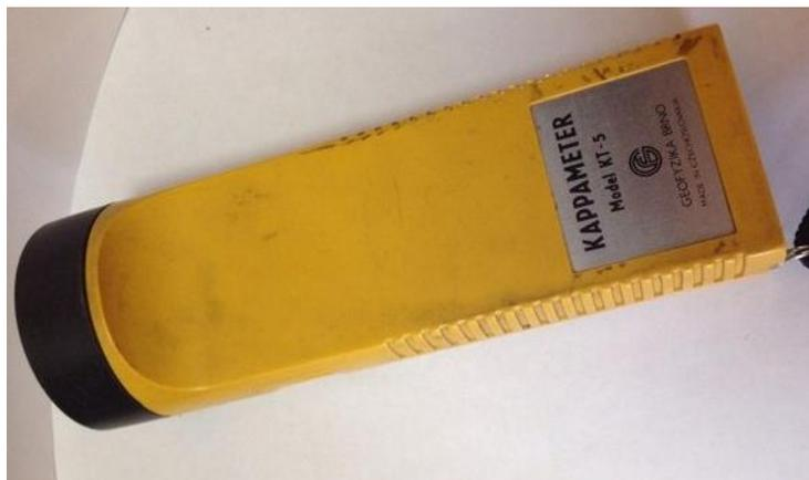
Рисунок 4.4.1. – Карраметр Model: КТ-5 для измерения магнитной восприимчивости почв
