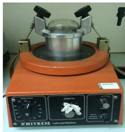
Рисунок 4.3.1. «Измельчитель «FRITSCH GmbH, Laborgerätebau», лаборатория «ИЕЕС Париж»
