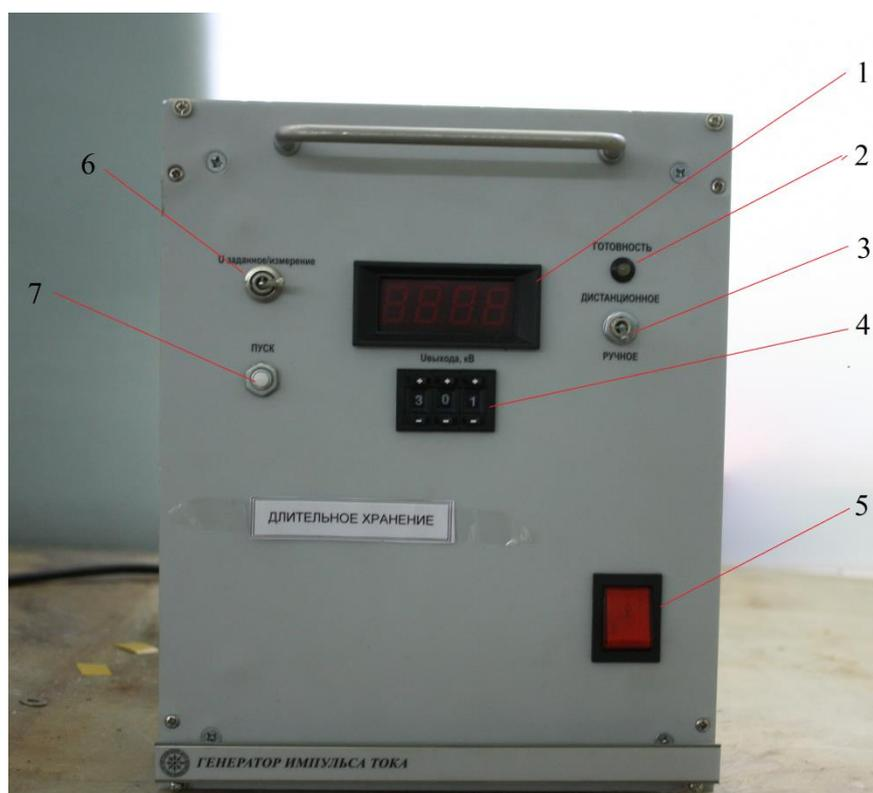
Рисунок 10 – Фотография генератора импульсов тока: 1– индикатор высокого напряжения; 2– индикатор срабатывания; 3– переключать дистанционного и ручного управления; 4– прецизионный переключатель, позволяющий задать уровень напряжения в ручном режиме с точностью до десятков вольт; 5– сетевой выключатель; 6– выключатель высокого напряжения; 7– кнопка «Пуск».
