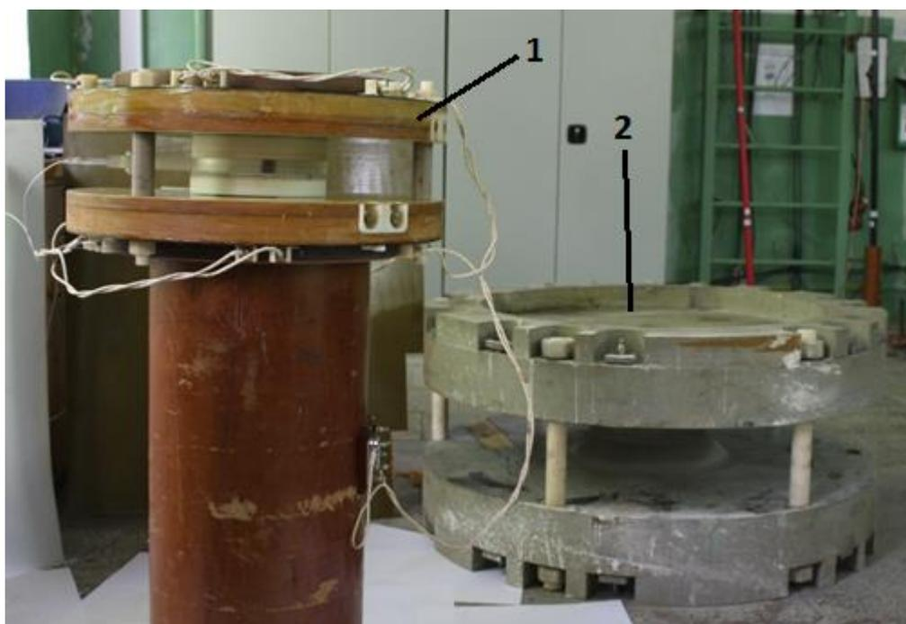
Рисунок 11 – Фотография электромагнита: 1– электромагнит установок БИМ117М; 2– электромагнит установок БИМ234.3000
