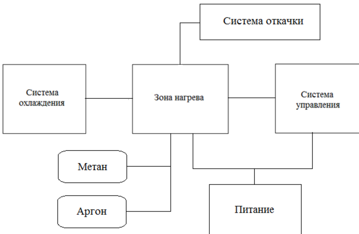
Рисунок 2.2 — Блок-схема процесса обжига таблеток.
