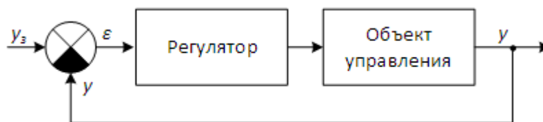
Рисунок 43 - Структурная схема модели регулирования по отклонению
