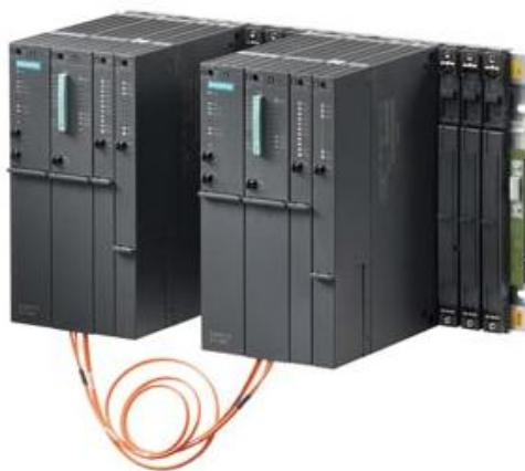
Рисунок 1 - Резервированная станция автоматизации Siemens S7-400F/H
