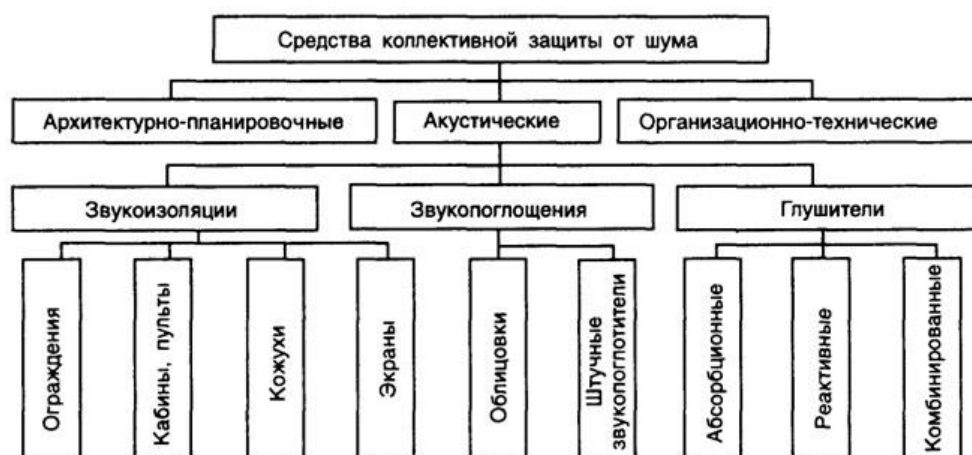
Рисунок 8 - Средства коллективной защиты от шума на пути его распространения.
