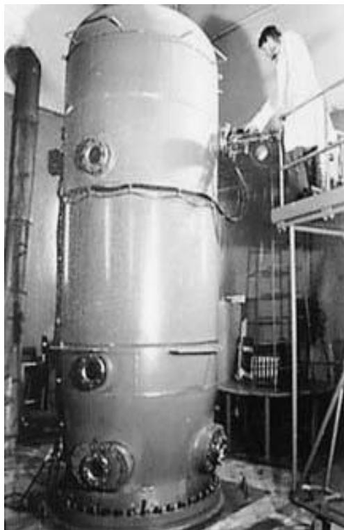
Рисунок 5 – Электростатический генератор (ЭСГ-2,5 МэВ).
